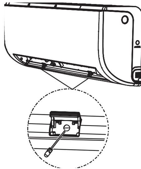
**Монтаж блока на пластину**
