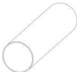
Рис.11 Труба ПНД 132х3,5 (Гильза) (Дополнительная комплектация)
